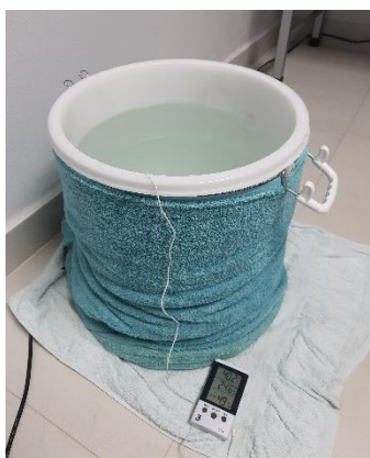
ภาพที่ 1 แสดงลักษณะของถังน้ำร้อนอย่างง่ายและขั้นตอนการเก็บข้อมูล
